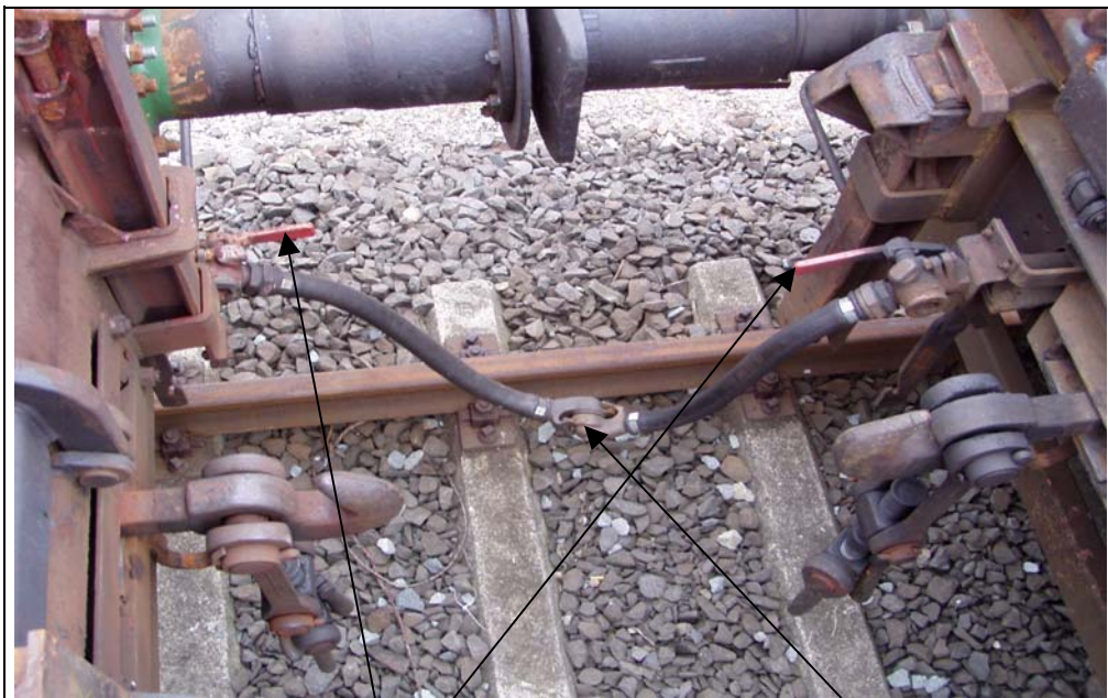
Bild 3 Bremskupplung der Hauptluftleitung zweier Güterwagen; Luftschläuche verbunden; Luftabsperrhähne geöffnet (d.h. Handgriffe in waagerechter Stellung)
